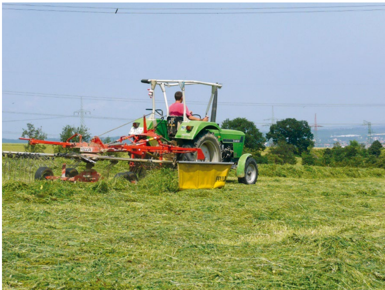
Abbildung 3: Zetten und Wenden mit Kreiselzettwender
