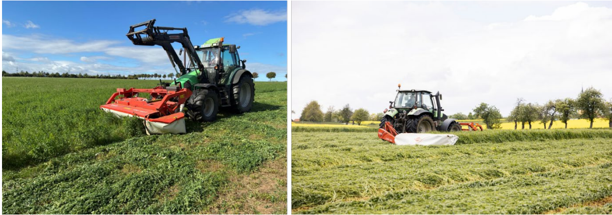
Abbildung 2: Mähen mit Frontmähwerk links und Front-Heck-Kombination rechts
