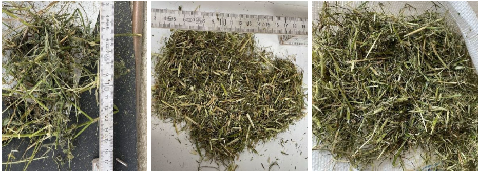
Abbildung 7: Luzerneheu v. l. Rohmaterial, Fraktion aus 2mm Siebeinsatz und Beispiel einer Grobfraktion
