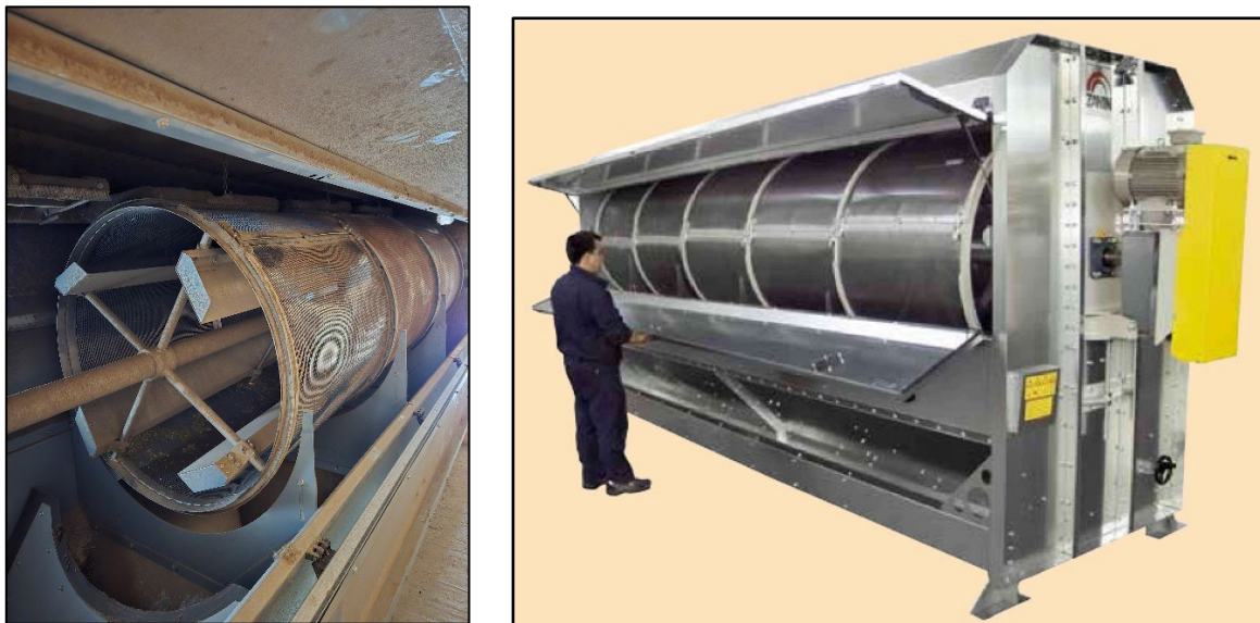
Abbildung 2: Siebeinsätze im Trommelvorreiniger bei VWP, links und Beispielbild Trommelvorreiniger der Firma Zanin, rechts
