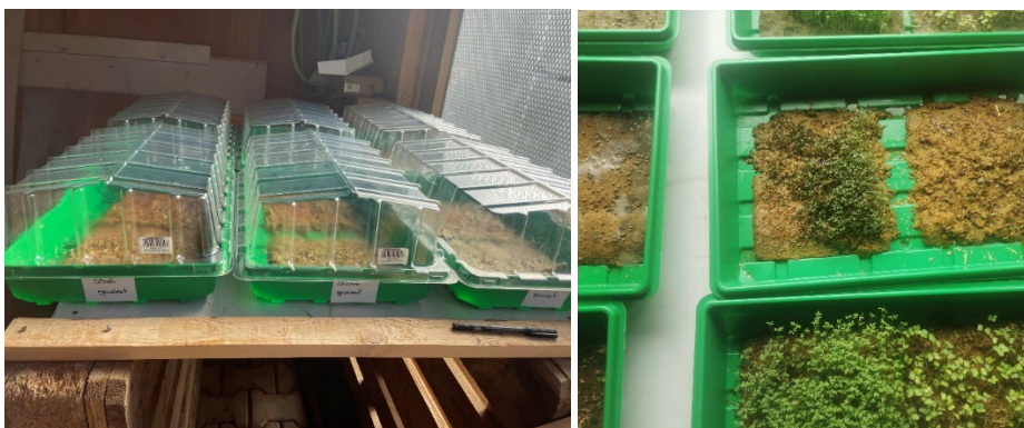
Abbildung 5: Versuchsaufbau Anzuchtsubstrate Versuch 2 (links), gehemmtes Wachstum auf den Luzernesubstraten bzw. Schimmelbildung im fortgeschrittenen Versuchsverlauf (rechts)
