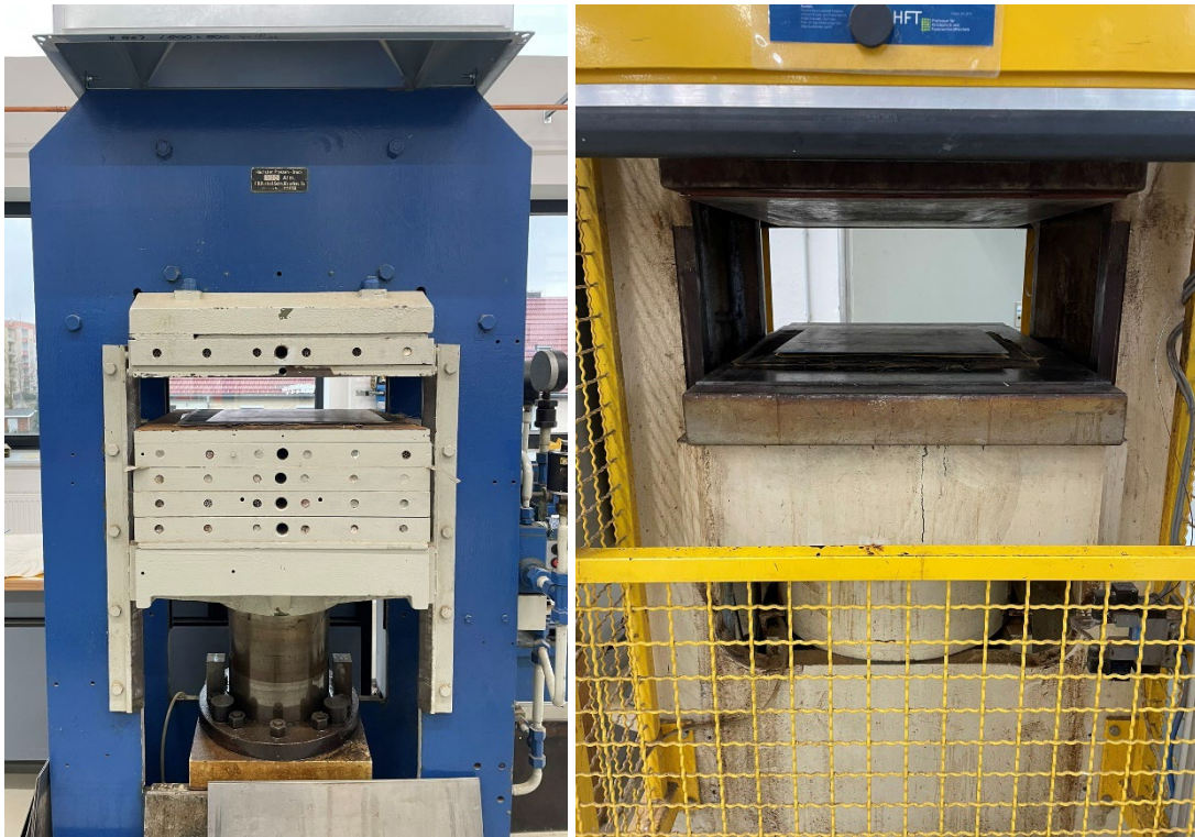
Abbildung 1: Presse der Firma Ruck zum kalten Verpressen der Wirtvliese (links) und Heißpresse von Siempelkamp, Ansicht der beheizten Pressplatten (rechts)
