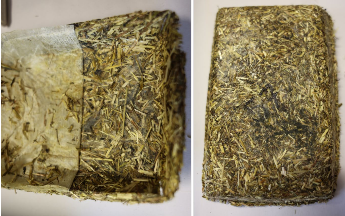
Abbildung 16: Fehlerhafte Wasserdichtigkeit bei den eingepressten Wachstissues und daraus resultierender Schimmel
