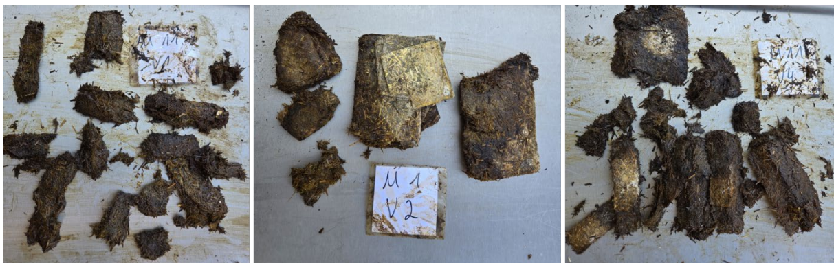
Abbildung 15 Verschiedene Prüfkörper in der Gruppe Luzernefasern, Luzernepressformen ohne Additive in verschiedenen Zuschnitten nach der ersten Probeentnahme
