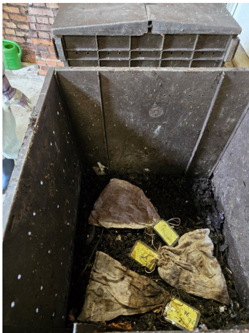
Abbildung 6: Industrieller Kompostierungsversuch, Einschichtung der Proben
