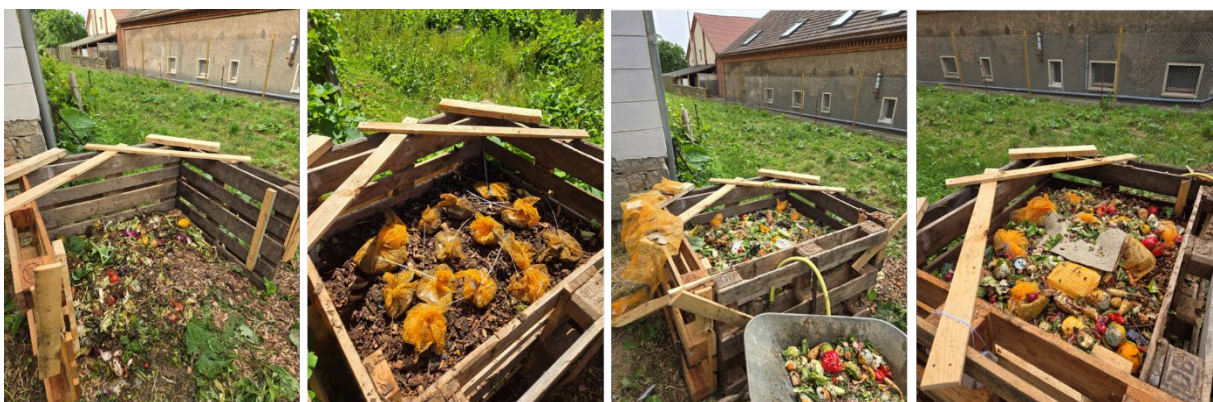
Abbildung 10: Einbringen der Prüfkörper im Heimkompostversuch
